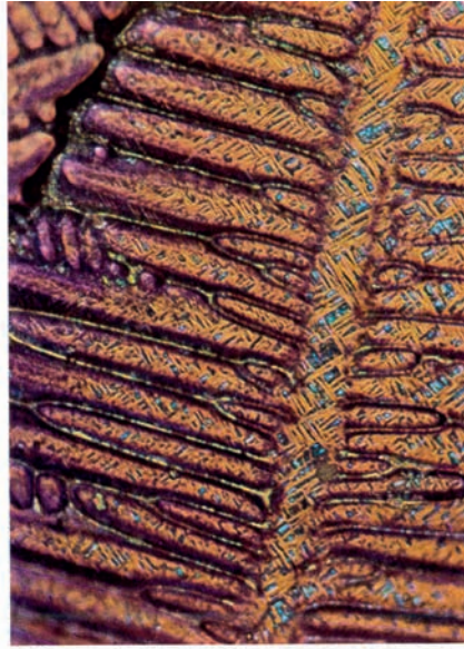
Bild 2. Dendrit mit Fehlorientierung und Lamellen der \alpha -Phase (Originalvergrößerung 180 \times , Nachvergrößerung 600 \times )
