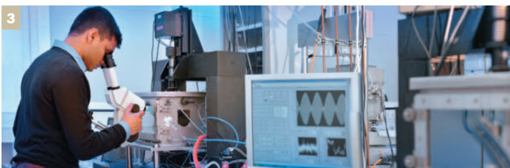
Abbildung 3: Analyse von Korrosionsprozessen mit der Rasterkelvinsonde • Copyright: Frank Vinken.
