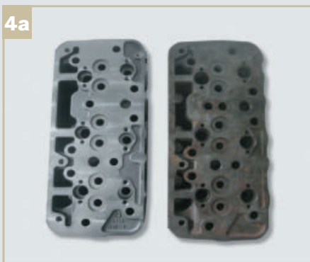
Ein circa 60 Jahre alter Oldtimer-Zylinderkopf (50 cm hoch, 30 kg schwer) wurde mittels Computertomografie (Linearbeschleuniger und Zeilendetektor) untersucht, um die Möglichkeiten einer Reparatur zu bewerten und einen Neuaufbau des Bauteils vorzubereiten. 2D-Schnitte und 3D-Volumen zeigen deutlich die nach heutigen Maßstäben schlechte Fertigungs-
