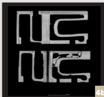
qualität und die Folgen früherer Reparaturversuche: Schlackestereste, Poren, Lufteinschlüsse, ungleichmäßige, erhöhte oder zu geringe Wandstärken sowie Undichtigkeiten sind im kompletten Bauteil zu finden. Auf Basis der CT-Daten konnte der Zylinderkopf nachkonstruiert und mit aktuellen Fertigungsmethoden neu abgegossen und aufgebaut werden.
