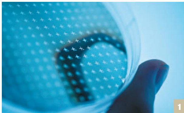
Abbildung 1: Materialbibliothek mit über 340 Proben auf einem 100 mm Si-Wafer (Foto: Nielinger).
