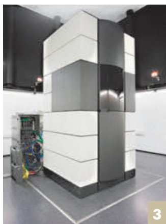
Abbildung 3: PICO, das zweite Transmissionselektronenmikroskop weltweit mit einem Korrektur für die chromatische Aberration.
