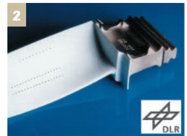
Abbildung 2: Mittels Elektronenstrahlverdampfung hergestellte Wärmedämmschicht aus teilstabilisiertem Zirkonoxid auf einer Hochdruckturbinenschaufel.
