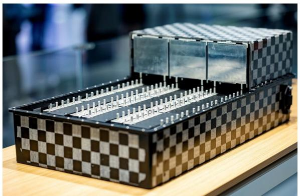
Figure 1. Funktionsfähige Traktionsbatterie mit thermoplastbasiertem Gehäuse auf dem Batterieprüfstand am Fraunhofer LBF
