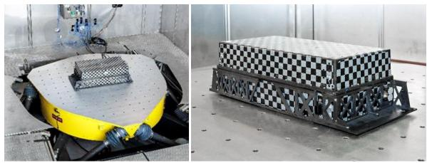
Figure 2. Funktionsfähige Traktionsbatterie mit thermoplastbasiertem Gehäuse auf dem Batterieprüfstand am Fraunhofer LBF
