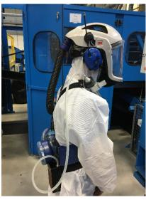
Abb. 1: Mitarbeiter in Arbeitsschutzkleidung mit angelegtem Probenahmesystem.
