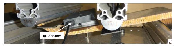
Abbildung 12. Schadenfalls bei obenliegendem RFID-Tag, Bruch in der oberen Decklage
