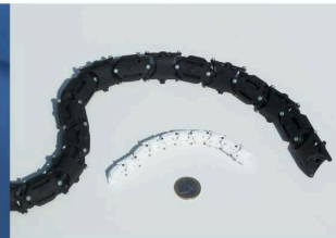
Abbildung 3: Rüssel mit Arretiermechanismen (programmierbare Steifigkeit)
