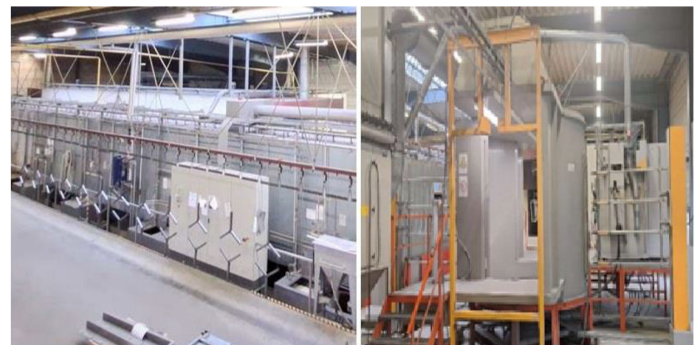
Abbildung 2. Vorbehandlungslinie (links) und Pulverbeschichtung (rechts) bei der MPL GmbH
