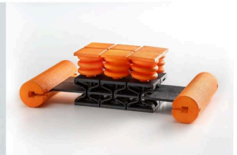
Abbildung 4: Programmierbare Dämpfung mit dehnungsabhängigen Drosselventilen
