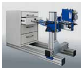
Dieses Möbel-Prüffeld führt Dauerbelastungstests an Schubläden, Auszügen und Funktionsbeschlägen aus.
